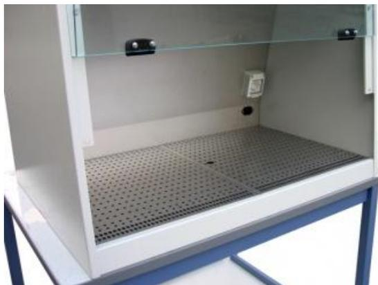
Carpenteria esterna in lamiera di acciaio verniciata a polvere epossidica a forno
